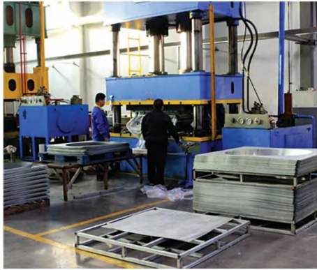
专业的集风机成型压力机，压力控制精确，冲压速度快，有效保护镀锌层完整性，增强防锈性能。
