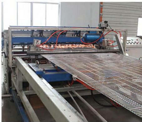
专业的自动保护网焊机，热镀锌丝自动剪切和焊接，再喷漆，防腐防锈能力强。
