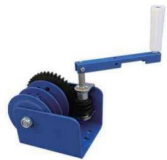
额定工作载荷 Rated Load: 1500Lbs (680Kg) 传动比 Ratio: 41:1 滚筒直径 Roller Diameter: 49mm 热处理 Heated Process: 蜗杆 Worm 蜗轮 Worm Wheel 表面处理 Surface Proess: 镀铬 Chrome 喷涂 Spray 主要用于 Application: 侧风窗 Air inlet
