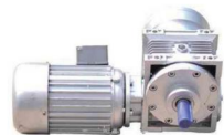
电机功率 Power: 500W 电压 Voltag: 380V 频率 Frequency: 50HZ 转速 Rated Speed: 1400转/分RPM 速比 Ratio: 700:1 扭矩 Torque: 500 NM 使用于 Application: 侧风窗 Air inlet
