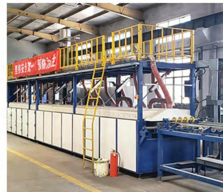
全自动湿帘生产流水线，由电脑精准控制，自动化程度高，生产效率高，所产湿帘纸波纹均匀、结构紧密、吸水性能优异。
