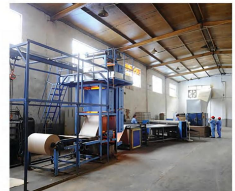
我司自主研发设计的湿帘生产线设备，结构合理，运行稳定，生产效率高，可满足客户自建工厂生产湿帘的需求。
