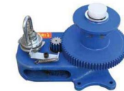
额定工作载荷 Rated Load: 3500Lbs (1500Kg) 传动比 Ratio: 38:73:1 滚筒直径 Hub Diameter: 93mm 表面处理 Surface Proess: 镀铬 Chrome 喷涂 Spray 主要用于 Application: 料线 Feeding line
