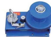
额定工作载荷 Rated Load: 3000Lbs (1360Kg) 传动比 Ratio: 38:73:1 滚筒直径 Roller Diameter: 93mm 表面处理 Surface Proess: 镀铬 Chrome 喷涂 Spray 主要用于 Application: 料线 Feeding line
